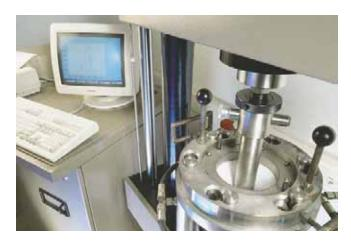
1 Stempeldurchdrückversuch – hierbei wird das Durchdrücken eines Steines durch ein Geotextil simuliert und dient zur Klassifizierung der Robustheits-klasse auch von Vliesstoffen Foto: NAUE
